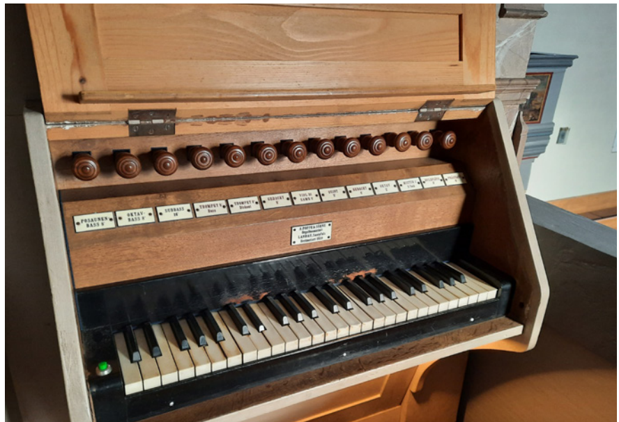
Der von Poppe vorgebaute Spieltisch In der Mitte ist das Firmenschild der Orgelbau-firma Poppe gut erkennbar
